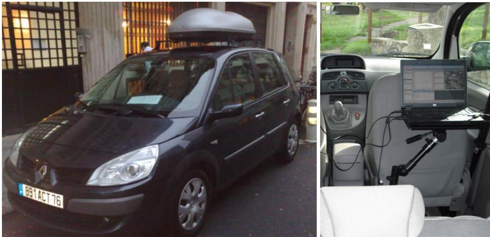
A l'intérieur du coffre de toit, les mobiles sont positionnés sur un support spécifiquement adapté, de manière stable, à la verticale, afin d'offrir les meilleures conditions radio possibles. La charge électrique des mobiles est assurée en continu pour garantir l'autonomie du dispositif et le fonctionnement optimal des terminaux au niveau radio.
