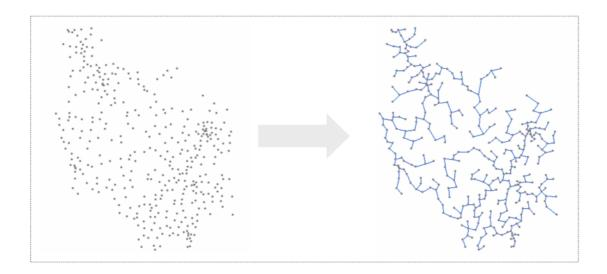
L'algorithme d'arbre couvrant minimal implémenté dans la brique de desserte correspond à l'algorithme de Kruskal. Celui-ci consiste à trier les arêtes possibles par ordre de longueur croissante, puis à les ajouter une par une au graphe en cours de construction, en vérifiant à chaque fois que l'ajout ne fait pas apparaître de boucle. Pour n nœuds, la complexité de l'algorithme de Kruskal est globalement en n.log(n).
