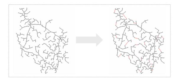
Le degré de bouclage varie entre deux situations : le réseau en « étoile » non bouclé, et le réseau complètement maillé. Afin de refléter la diversité des situations, le niveau de bouclage cible du tracé modélisé est paramétrable par l'utilisateur. Deux indices significatifs ont ainsi été retenus pour quantifier le degré de bouclage d'un graphe ; ces indices sont présentés en Annexe A.
