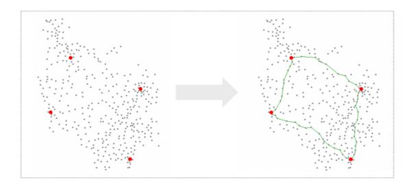
Le graphe obtenu en sortie de cet outil, généralement bouclé, n'est le plus souvent que partiel dans la mesure où il ne relie pas tous les nœuds renseignés en entrée ; il est alors possible d'avoir recours à la brique de desserte pour le compléter.
