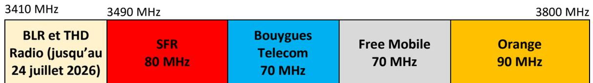
Figure 8 – Utilisation de la bande 3410 – 3800 MHz
