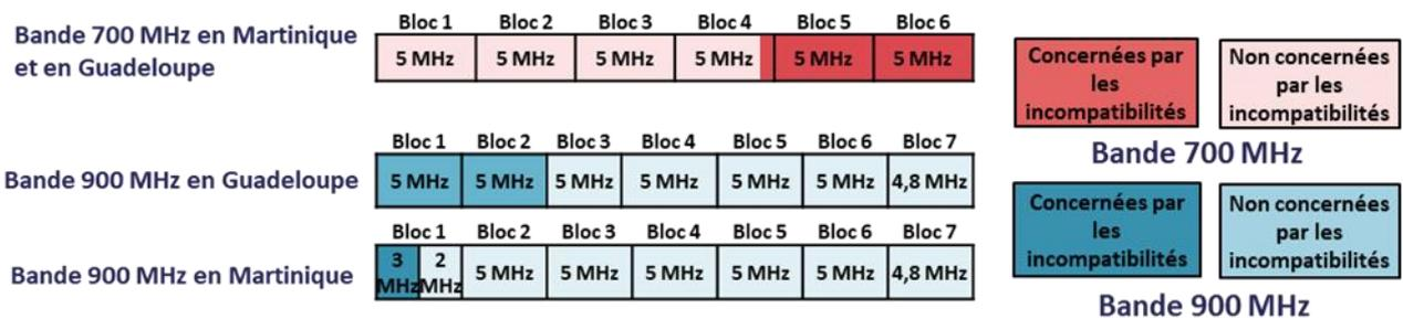
Figure 2 : Schémas des bandes 700 MHz et 900 MHz en Martinique et en Guadeloupe
