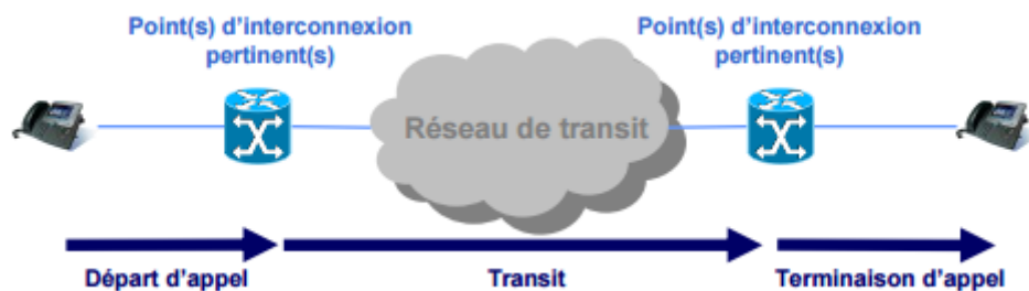
Figure 4 : Architecture générique d'une communication téléphonique
