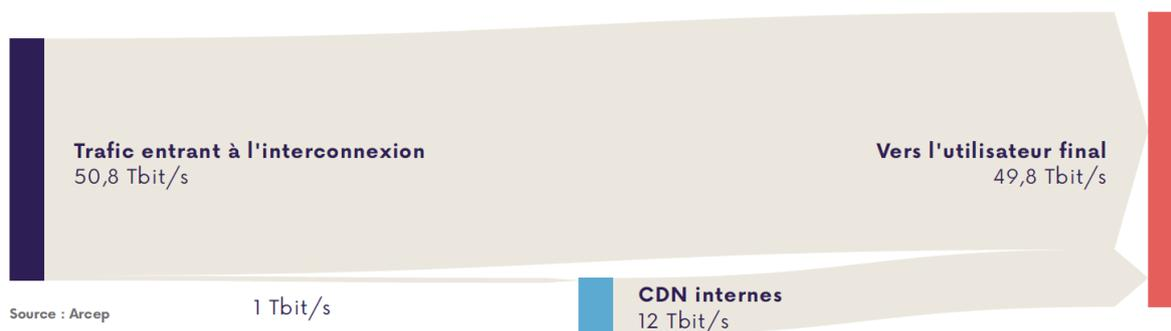
Figure 9 : Flux à l'interconnexion, et rôle des CDN internes
