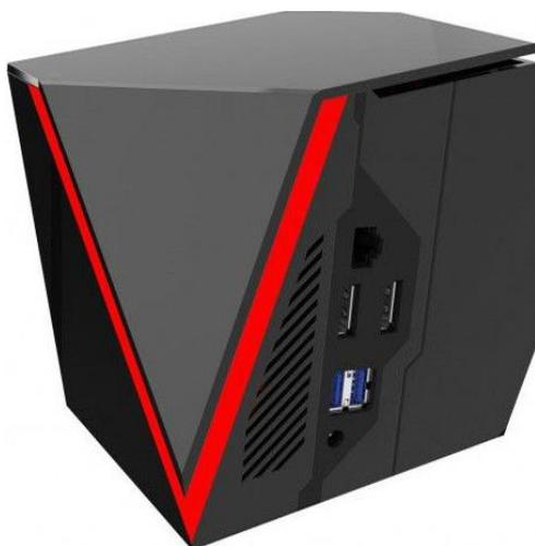
Le boîtier dispose de toutes les prises pour brancher une souris, un clavier, un écran, et se connecte en ligne au PC Shadow, sur lequel sont installés les logiciels (seul Windows est fourni) et sont stockés les fichiers.
