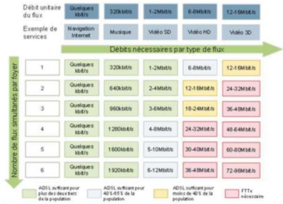
Figure 4.31 : Evolution des besoins en débit en fonction du multi-usage et du type de flux [Source : Analysys Mason]
