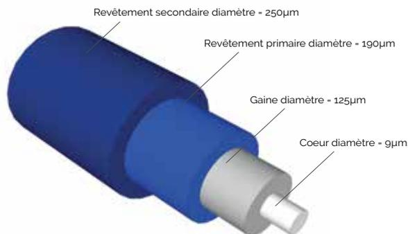
Fig. 75 | Structure d'une fibre optique
