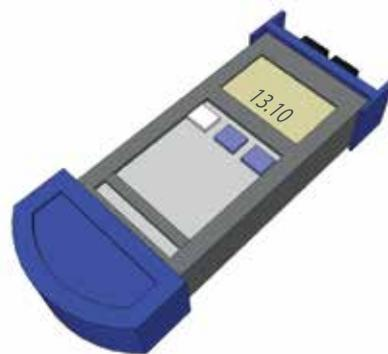
Le photomètre ou radiomètre est un récepteur de lumière qui permet de mesurer la puissance.
