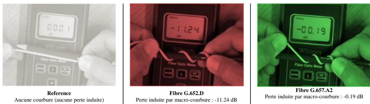
Figure 2 : Exemples de pertes induites par macro-courbures à 1550nm pour deux échantillons de fibres G.652.D et G.657.A2 en considérant deux tours complets autour d'un crayon à papier.
