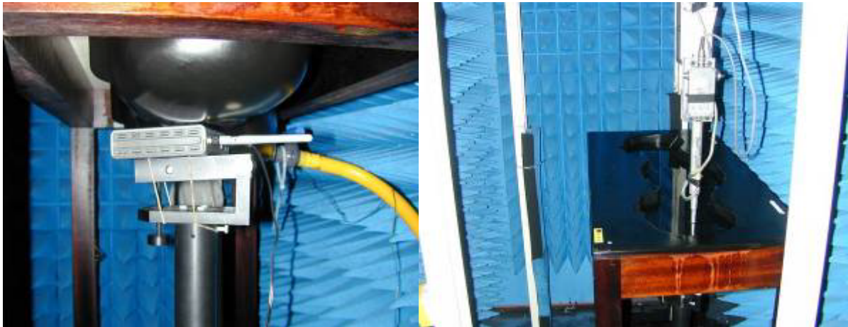
Photo 16 : Position du point d'accès sous le fantôme et sonde de mesure du DAS plongeant dans le liquide de référence.
