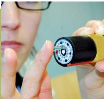
Test de continuité optique d'une fibre
