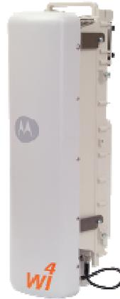
Ce type d'antenne est capable de couvrir un angle de 90°. 4 antennes seront alors nécessaires pour couvrir l'ensemble du périmètre soit 360°.
