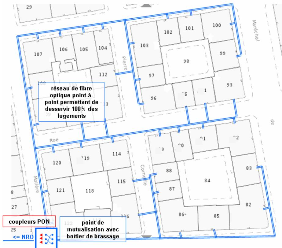
Dès lors, contraindre un opérateur PON qui aurait opté pour une architecture à deux niveaux de coupleurs à sortir le point de mutualisation du pied d'immeuble revient schématiquement à contraindre cet opérateur à tendre vers une architecture à un seul niveau de coupleurs, c'est-à-dire à remonter le second coupleur jusqu'au niveau du premier coupleur et à installer un point de mutualisation à ce niveau.
