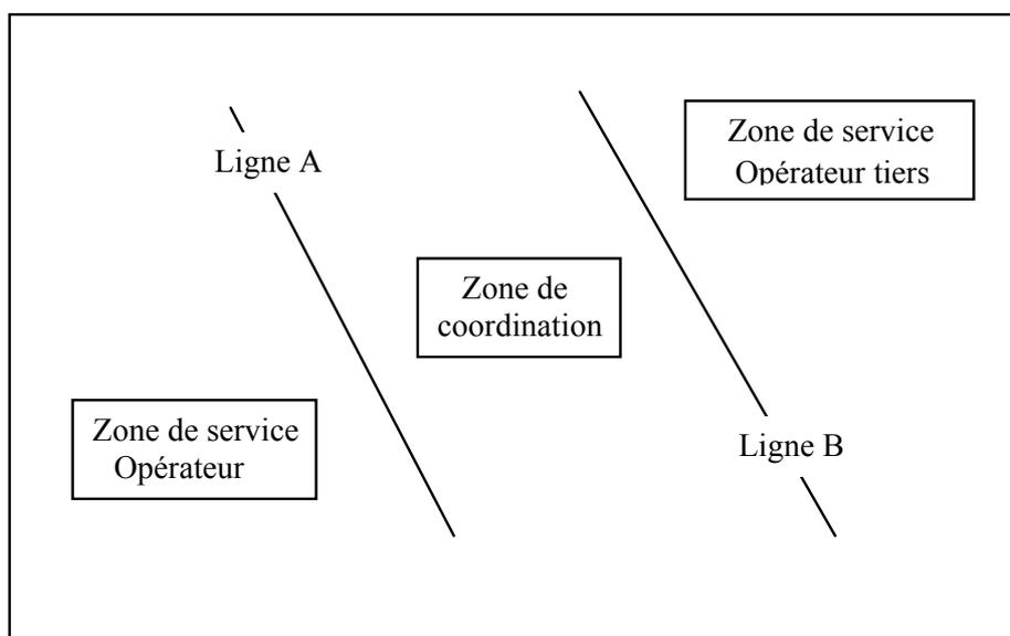
Un seuil de coordination est fixé à 37 dBµv/m, la hauteur de coordination étant fixée à 3 m au dessus du sol sur les lignes A et B. Les zones de coordination sont décrites en annexe 3.
