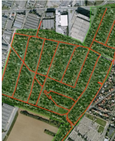
Ci-contre : exemple de réseau BT aérien
