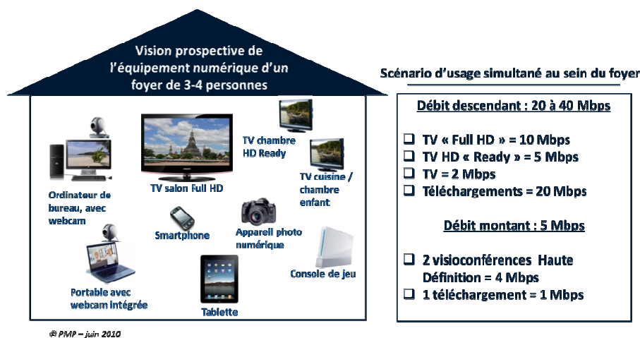
Scénario de besoins en débits des foyers – Etude CDC réalisée par le cabinet PMP
